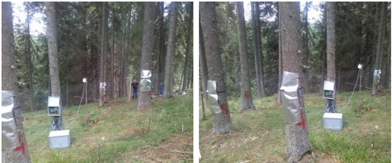
Слика 6 и 7. Постављање и калибрација опреме за праћење транспирације
