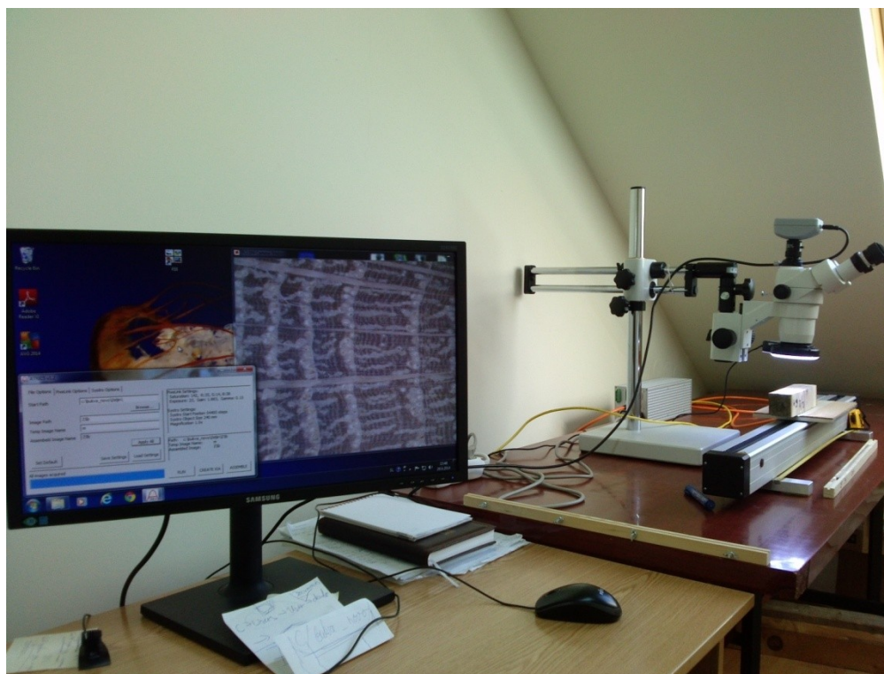
Слика 17. ATRICS систем за скенирање дендрохронолошких узорака
