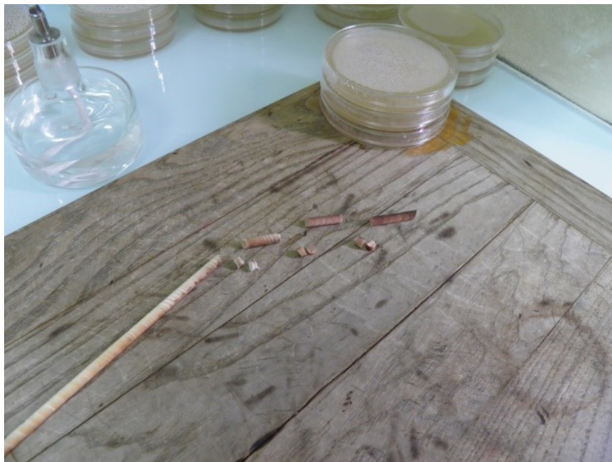
Слика 34. Изолација гљива (стављање фрагмената дрвета са извртака на кромпир декстрозни агар)
