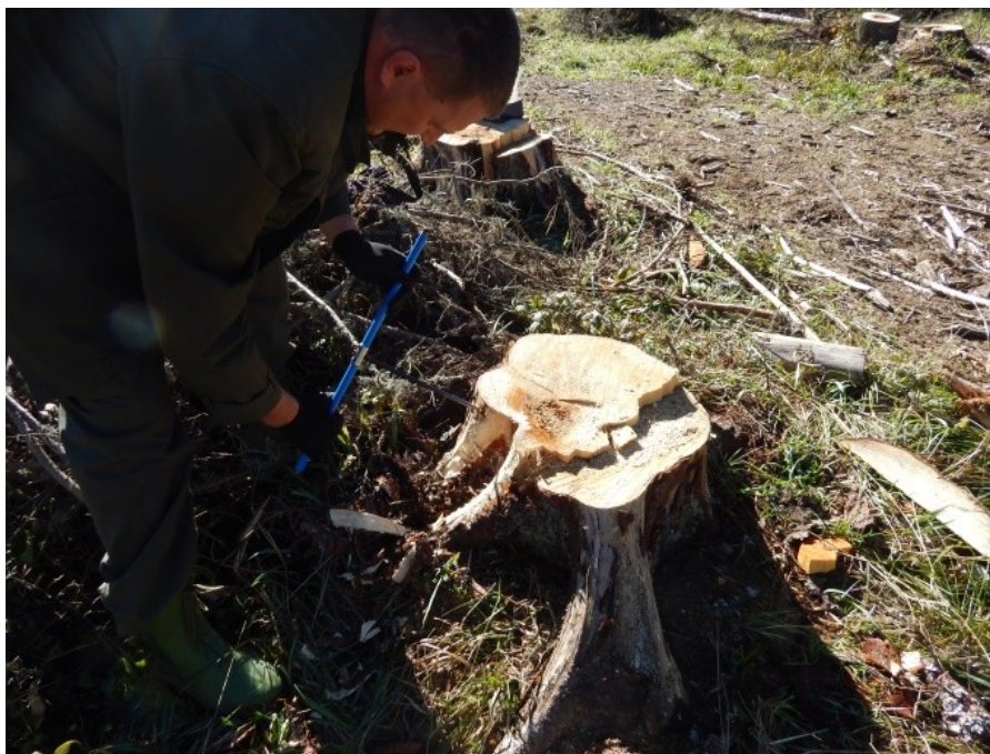
Слика 33. Извлачење извртка из пања смрче Преслеровим сврдлом
