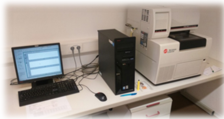
Слика 52. CEQ 8000 секвенцер (БЕЦКМАН ЦОУЛТЕР ЦО.) систем за анализу фрагмената
