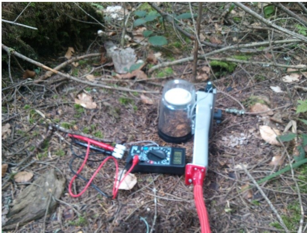
Слика 8. Мерење фотосинтезе на смрчи и дисања земљишта
