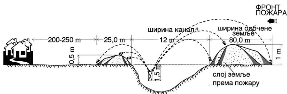
Слика 4. Пожарни канал изграђен усмеравањем земљишта у правцу горења
